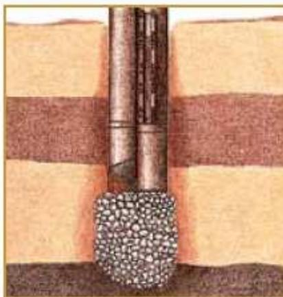
2. Щебень подается через трубу, параллельную виброфлоту, с помощью сжатого воздуха.
